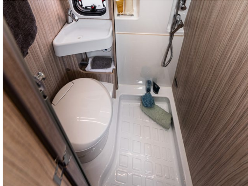
Vertiefter Duschteller: das Wasser fließt nicht in die Zone der Toilette.
