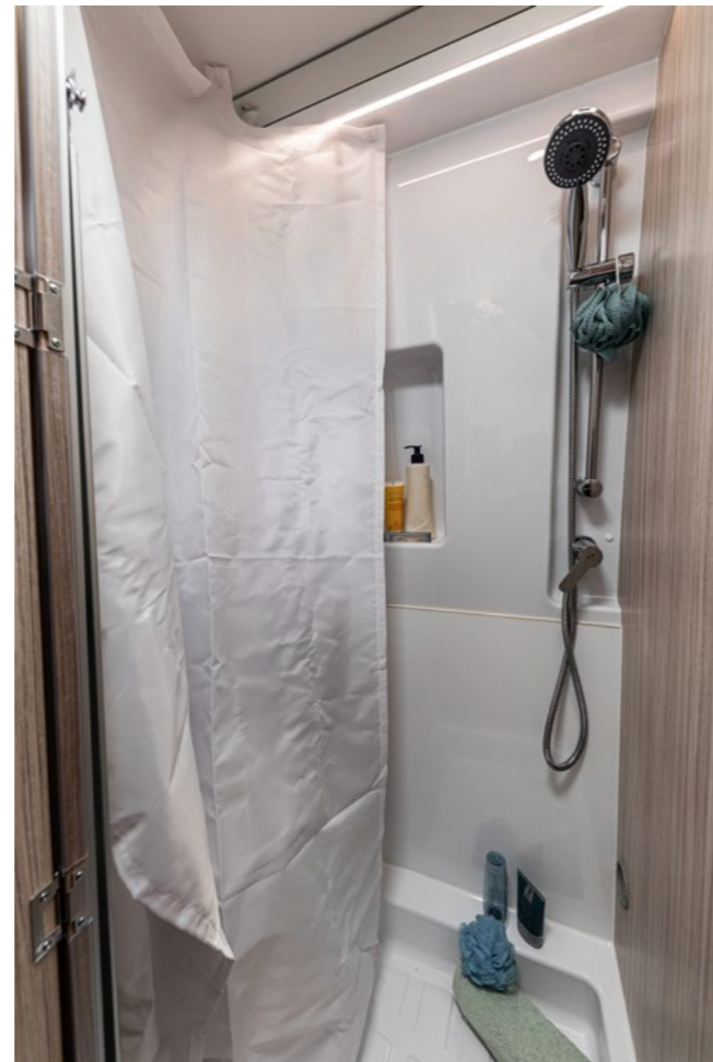
Mit Magneten befestigter Trennvorhang (E-Van2, E-Van5, E-Van DUO), kann zum Trocknen entfernt und bei Nichtgebrauch versorgt werden.
